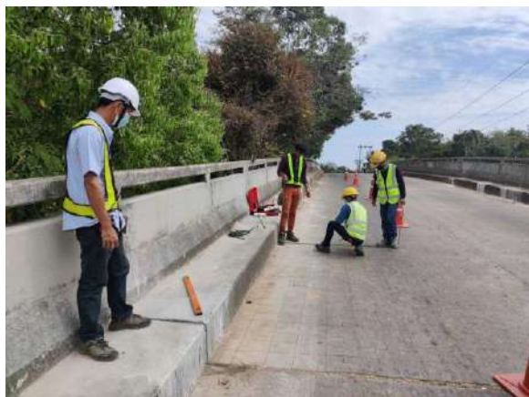
รูปที่ 11-5 รูปการสำรวจรายละเอียดเหล็กเสริมโครงสร้างสะพานด้วยเครื่อง GPR
