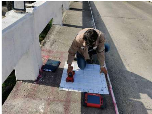
รูปที่ 10-5 รูปการสำรวจรายละเอียดเหล็กเสริมโครงสร้างสะพานด้วยเครื่อง GPR
